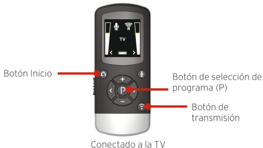
Los 3 dispositivos de transmisión Interton TV 2 están inicialmente marcados con las letras A, B y C, y el dispositivo en uso se muestra en la pantalla del mando a distancia.
