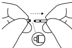
3. Inserte la punta de extracción en el filtro anticerumen usado y luego tire de la herramienta directamente hacia afuera. Es importante tirar en línea recta y no en ángulo.
