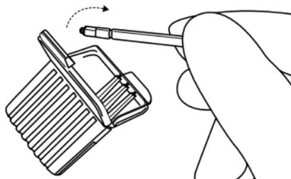
2. Abra la caja del filtro anticerumen y extraiga una de las herramientas. Cada herramienta tiene un pequeño gancho en un extremo (punta extraíble) y un nuevo filtro anticerumen en el otro.
