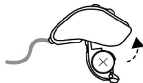
3. Inserire la nuova batteria, con il segno più (+) correttamente posizionato, nel vano batteria. **Non inserirla** direttamente nell'apparecchio acustico.
