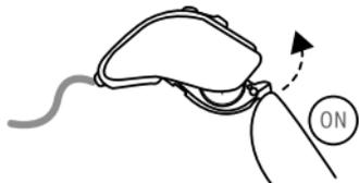
Per accendere l'apparecchio, chiudere il vano batteria.
