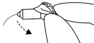
3. Controllare che la cupoletta sia montata in modo sicuro sollevandone con attenzione la parte inferiore e verificando che i petali coprano completamente l'estremità scanalata del tubetto.
